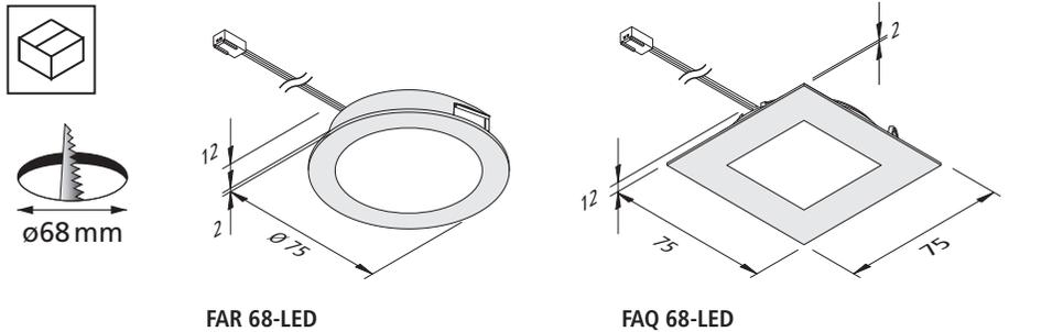
bei Dämmung Abstandshalter min. 50 mm verwenden
