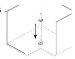
Avvitare il manicotto di fissaggio C sul cielo del mobile Screw the upper socket C on the top of the furniture
