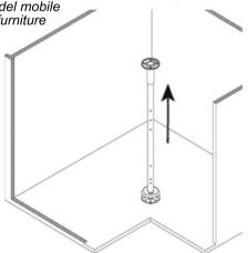
Inserire il cesto nel tubo posizionandolo con l'apposita vite ed avvitare il tutto nel piastrino sino al bloccaggio Insert the basket on the tube and place it with the supplied screw and screw all on the blocking racket till the blocking.
